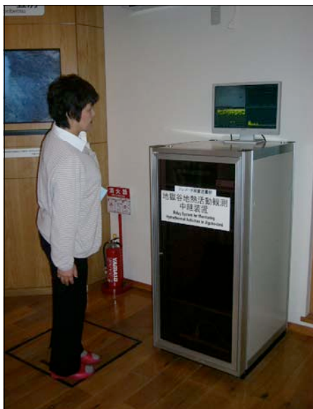
写真1. 登別パークサービスセンターに設置した中継装置を納めた筐体およびディスプレイ装置
