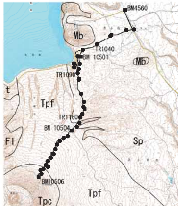
図1 北東登山道沿いの水準路線と地質分布。黒丸は1997年に北大によって取り付けられた水準点、黒四角は2001年に設置された水準点。地質分布は20万分の1地質図「札幌」（石田ほか、1980）による。Tpc:樽前山山体軽石丘、Tpf:樽前山軽石流堆積物、FI:風不死溶岩、Sp:支笏噴出物、Mb:紋別岳及び多峰山溶岩。
